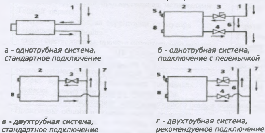
Рис. 1. Цифрами на рисунке обозначены: 1 - падающий стояк, 2 радиатор, 3 - терморегулятор (ручной или автоматический), 4 - вентиль нижний, 5 - воздухоотводчик (ручной или автоматический), 6 - перемычка (байпас), 7 - обратный стояк, 8 - заглушка.
